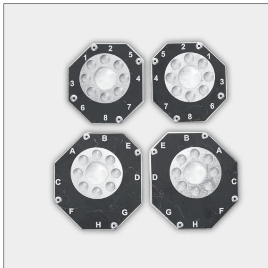
Roterende kalibre/specers for at undgå overkomprimering af røret og deraf følgende PE-fibre beskadiger
