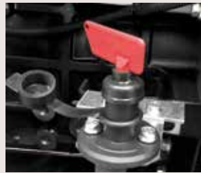
PALANCA PARA DESTACAR BATERIA BATTERY SWITCH
